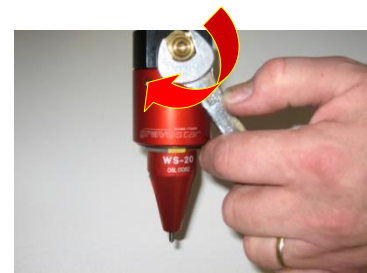
c) Kontermutter festziehen
