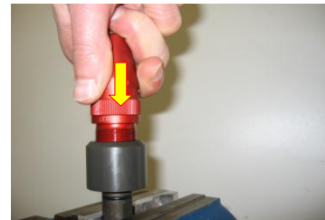
c) Beschriftungskopf mit etwas Gegendruck herausschrauben (Federvorspannung)
