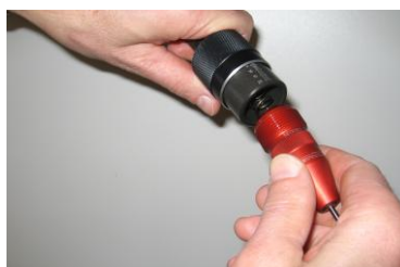
b) Nadelaufnahmhülse aus Aufnahmeadapter schrauben
