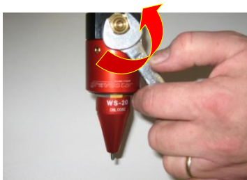
a) Kontermutter lösen (sw 13)
