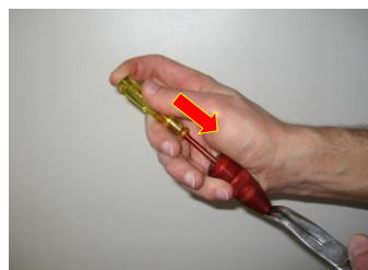
b) Nadel zurückdrücken und mit Zange festhalten
