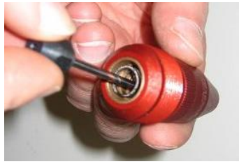
e) Nadel kann von Hand herausgezogen werden
