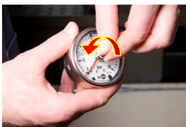
a) roter Schleppzeiger durch Drehen nach links auf Null stellen
