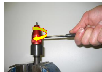
c) Beschriftungskopf mit Rundeisen festziehen
