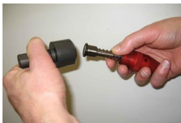
b) Beschriftungskopf von Hand in Adapter einschrauben
