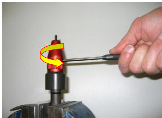
b) Werkzeug am Schaft einspannen und Beschriftungskopf lösen
