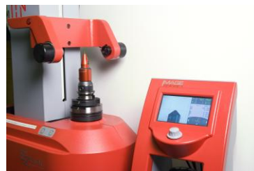
b) Werkzeuglänge ausmessen
