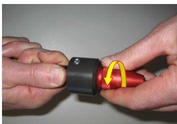
a) Beschriftungskopf von Hand aus Aufnahmeadapter schrauben
