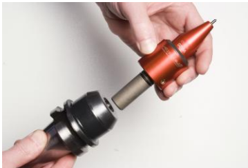
a) Werkzeug in WZ-Aufnahme einsetzen (bis an Anschlag eindrücken)
