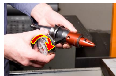
c) Manometer einschrauben und von Hand festziehen
