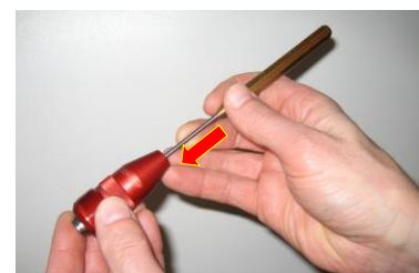
c) Beschriftungsnadel nach hinten aus Hülse schieben
