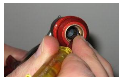
c) O-Ring mit Schraubenzieher ausbauen
