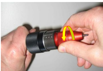
a) Nadelaufnahmhülse von Hand lösen
