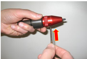
a) Rundeisen mit 4 mm Durchmesser in Entlüftungsbohrung ansetzen
