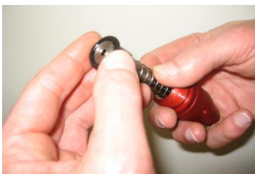
a) O-Ring auf Konus der Beschriftungsnadel aufsetzen
