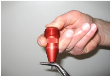
d) Zange entspannen (Abdeckung zuhalten, damit Feder nicht heraus springt)
